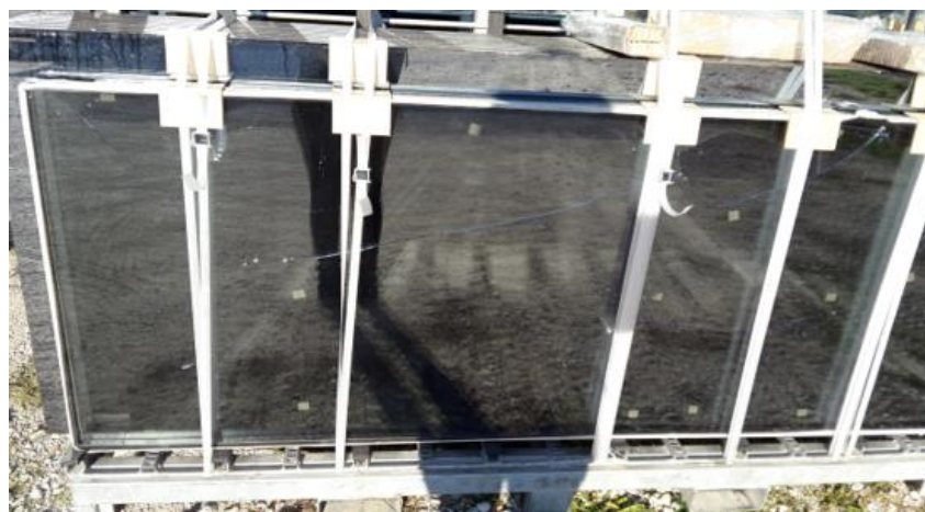
Slika 13.1.3., Lom stakla nastao skladištenjem stakla na nosaču pod otvorenim utjecajem sunca više dana (termo šok)
