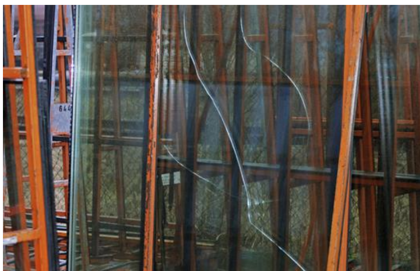
Slika 13.1.2., Lom stakla prouzrokovan pogrešno pozicioniranim podloškama čija pozicija nije iza letve za stezanje, već pored
