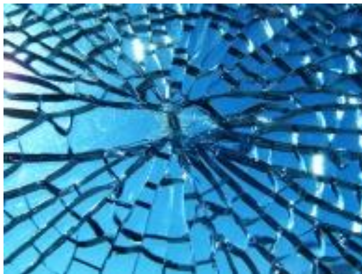
Slika 3.2.7.2., Izgled loma uslijed aktiviranja molekule NiS
