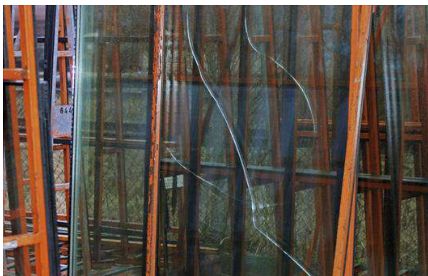
Slika 10.2.2., Lom stakla prouzrokovan pogrešno pozicioniranim podloškama čija pozicija nije iza letve za stezanje, već pored
