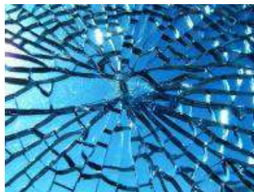
Slika 3.2.8.2., Izgled loma uslijed aktiviranja molekule NiS
