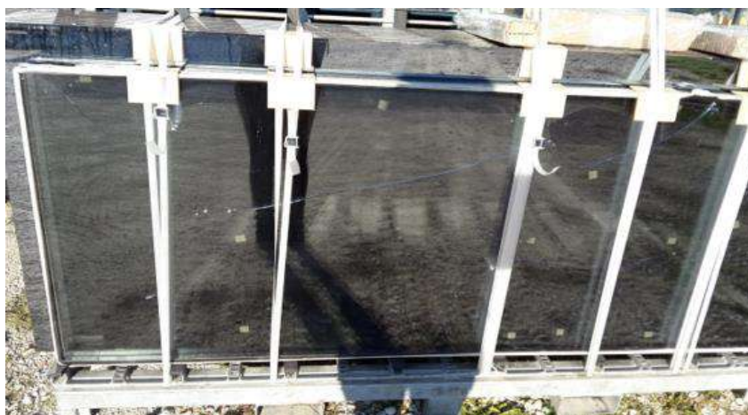
Slika 10.2.3., Lom stakla nastao skladištenjem stakla na nosaču pod otvorenim utjecajem sunca više dana (termo šok)
