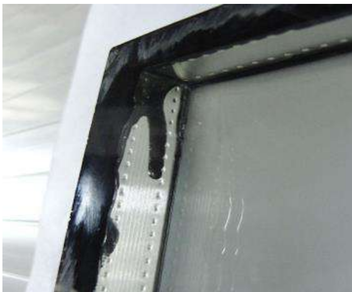
Slika 10.2.7., Tipične greške kod korištenje nekompatibilnih materijala u kombinaciji jedan sa drugim
